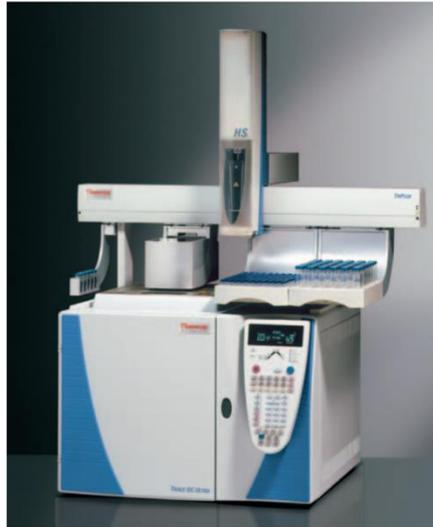
*Ilustración 17: Equipo TRACE GC Ultra utilizado para hacer el análisis de la cromatografía gaseosa*
