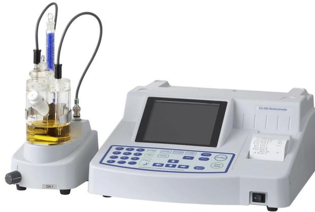
*Ilustración 15: analizador de humedad*
