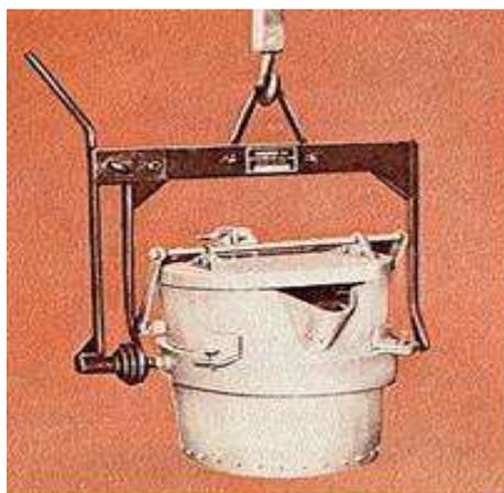
Figura x – Balde convencional para traslado de aluminio líquido.
