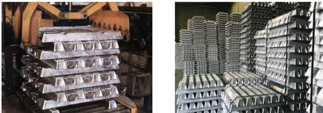
Figura 8- Traslado y almacenamiento de lingotes de aluminio.
