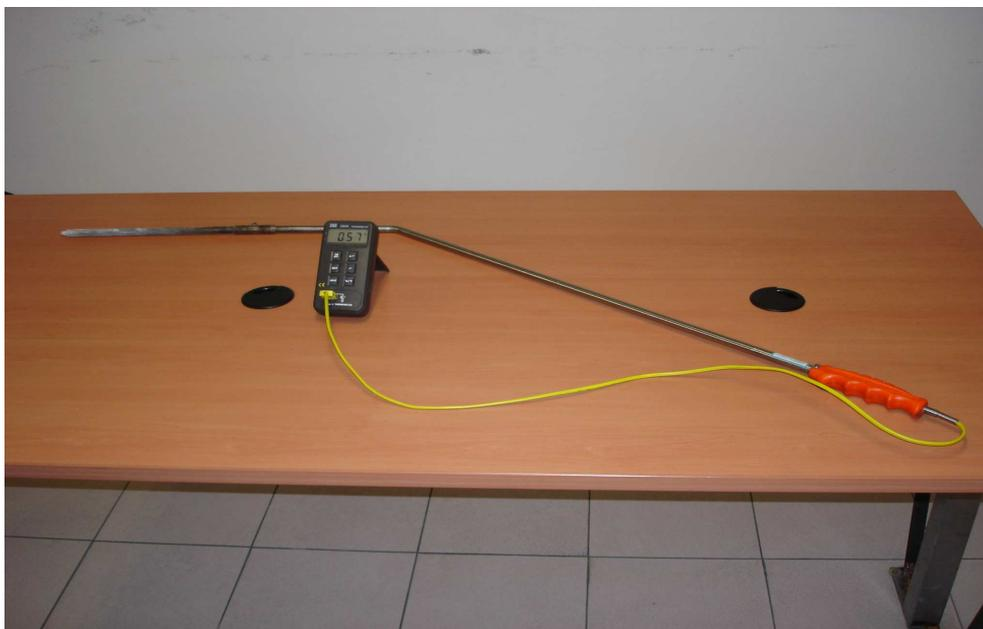
Figura x – Pirómetro termoelectrico utilizado en Bremet S.A.
