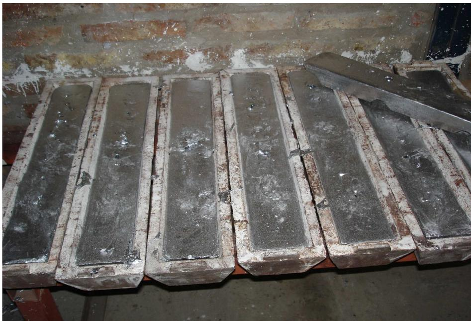
Figura x – Lingotera para solidificar el material.
