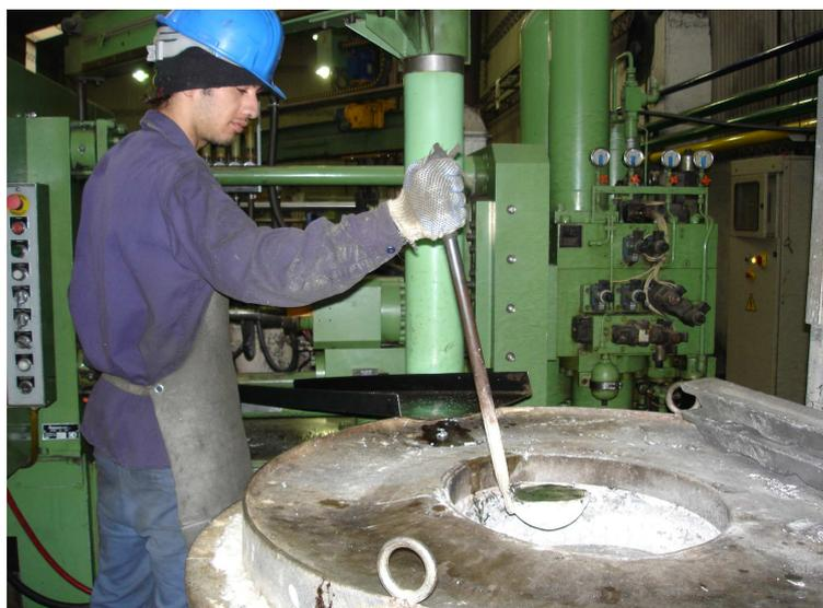
Figura x – Transferencia de material líquido con cuchara.
