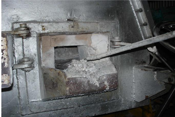
Figura x – Desescoriado del proceso de fusión.
