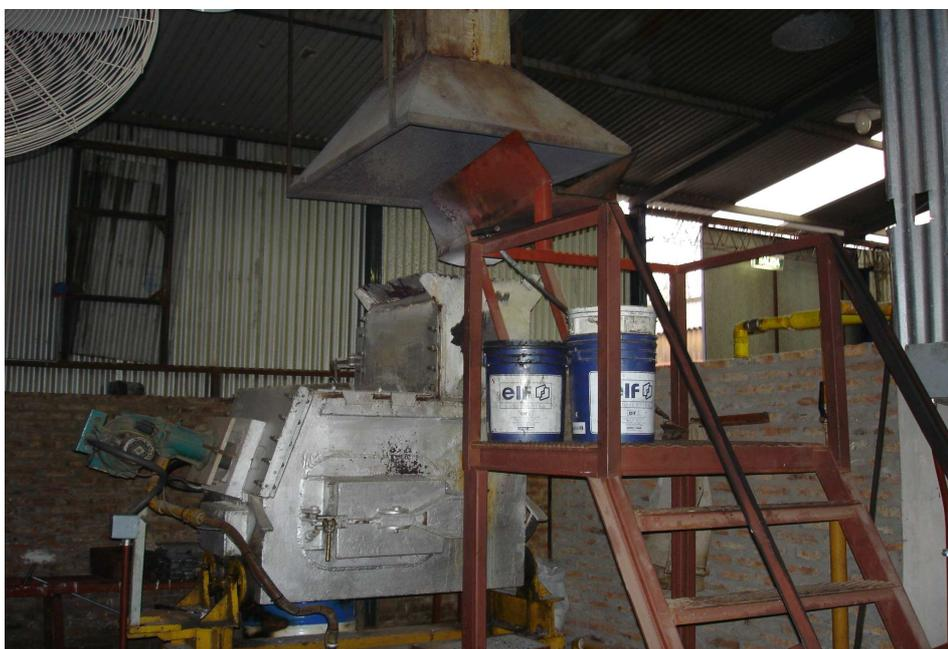
Figura x – Horno Scener. Carga de material por la chimenea.
