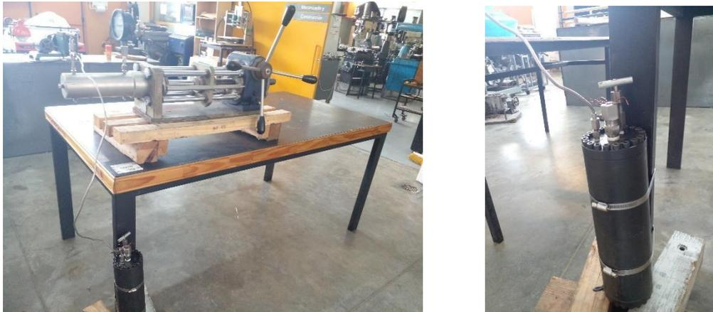
**Figura 4.5.2-2.** Bomba utilizada (izq.) y montaje de la prueba hidráulica de los *feedthroughs* (der.).
