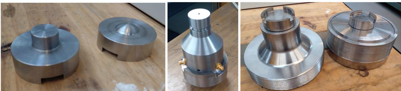
**Figura 4.4.1-1.** Pusher y Catcher (izq.), ajuste con sensor ultrasónico (centro) y calzado entre Pusher y Catcher y Tapa Superior Interna y Cuerpo Sellos (der.), respectivamente.
