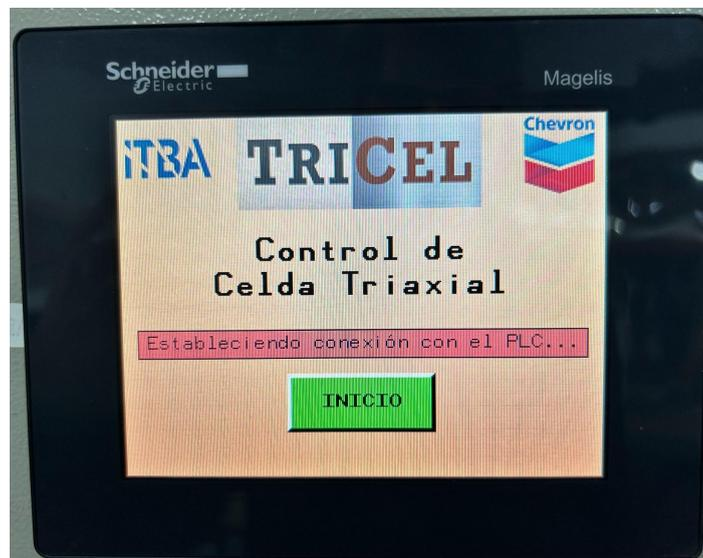
**Figura 7.3.1-1.** Pantalla de inicio del programa de control de la Celda Triaxial.
