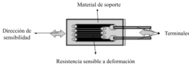
**Figura 6.2-1.** Esquema constructivo de un strain gage.
