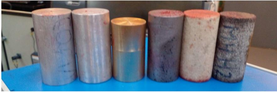
**Figura 10.2-1.** Probetas ensayadas (en orden izq. a der.): Aluminio Copia, Aluminio Patrón, Latón, Acero, Roca Patrón, Roca M4112.
