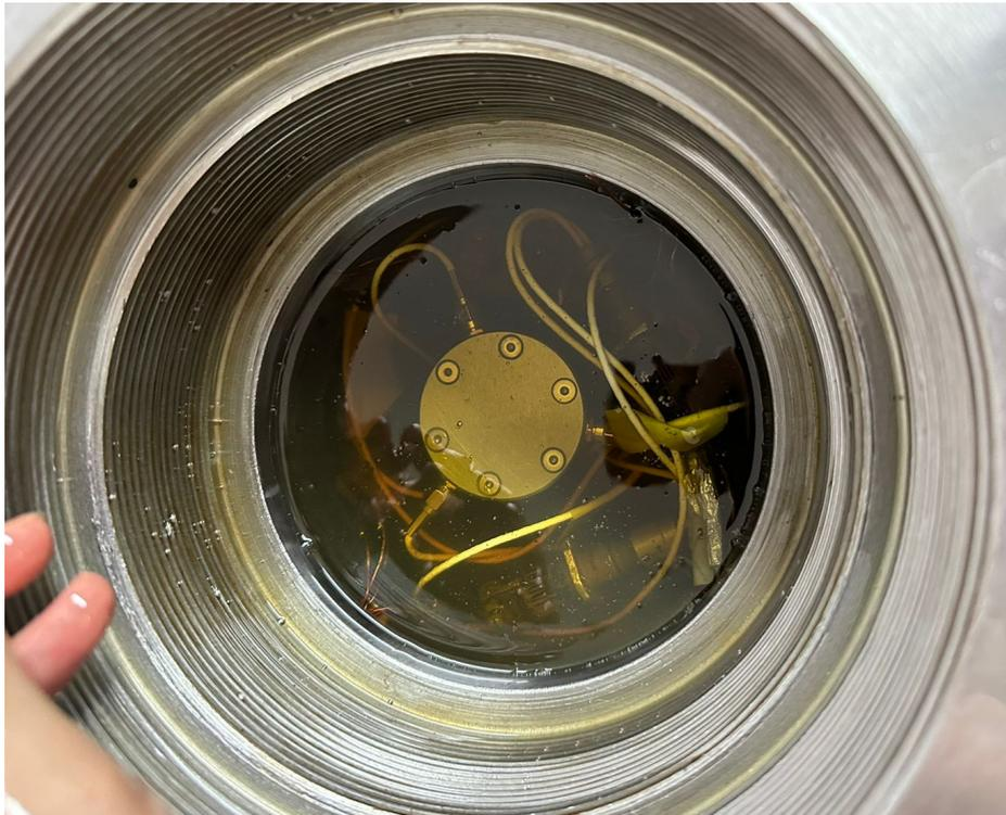
**Figura 12-1.** Disposición de sensores para ensayo ultrasónico con presión de confinamiento.
