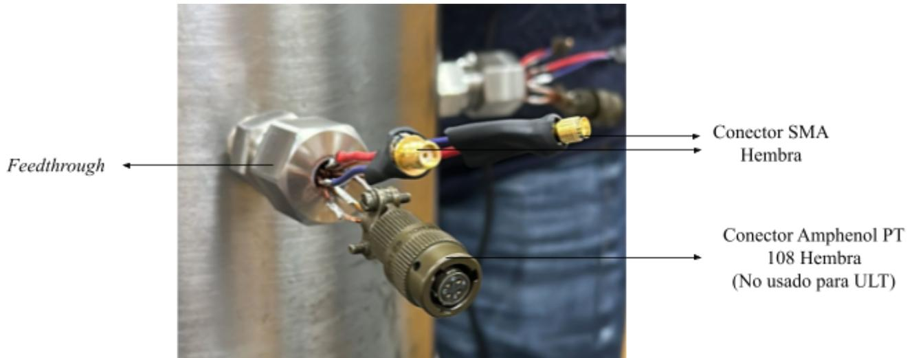
**Figura 6.1-4.** Conexiones externas.
