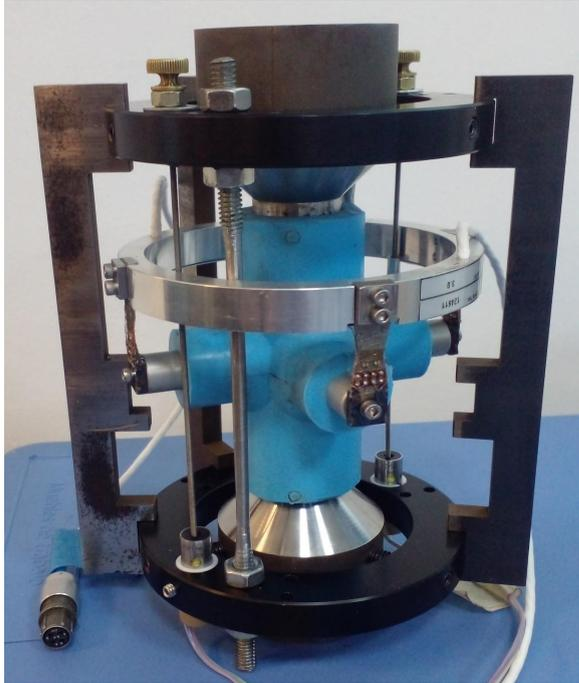
**Figura 6.6-7.** Alineadores de LVDTs en posición.
