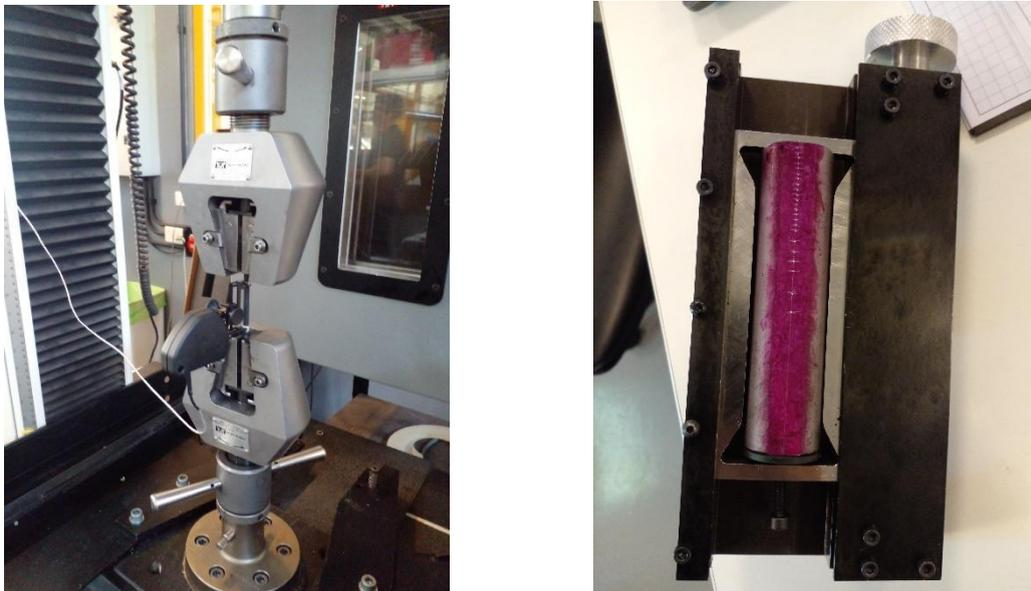
**Figura 4.8.2-1.** Montaje de ensayos de tracción (izq.) y medición de dureza de Jominy (der.).
