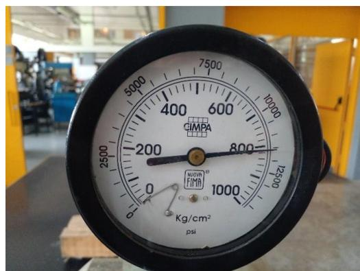
**Figura 4.5.2-3.** Presión máxima alcanzada en la prueba hidráulica, sostenida por 22 horas.
