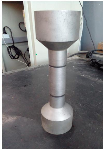
**Figura 4.4.2-1.** Sujetadores de probeta con una probeta metálica entremedio.
