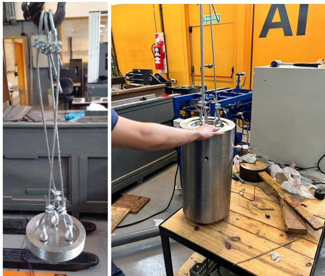
**Figura 4.7.3-1.** Cables de izaje sosteniendo a la Tapa Superior Interna (izq.) y a toda la celda (der.).
