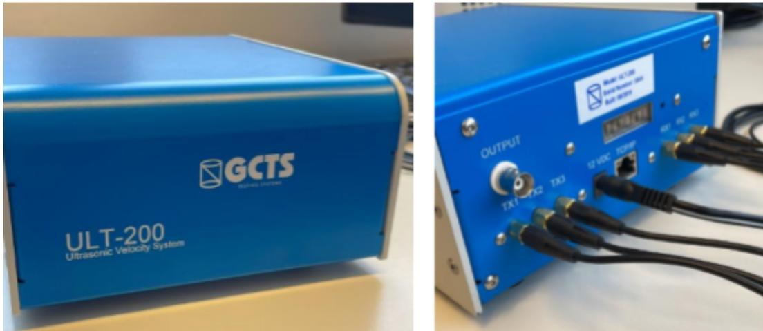
**Figura 6.1-2.** Módulo ULT-200. Adquisidor y acondicionador de ondas.
