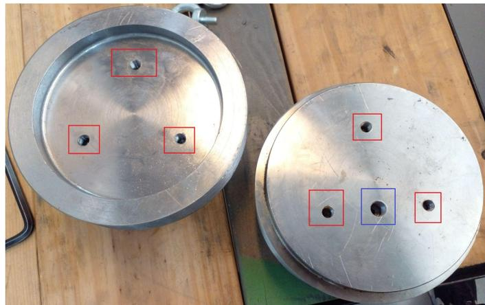
**Figura 4.3.1-1.** Tapa Superior Interna y Porta Pistón. Agujeros para cáncamos (rojo) y entrada de presión de pistón (azul).
