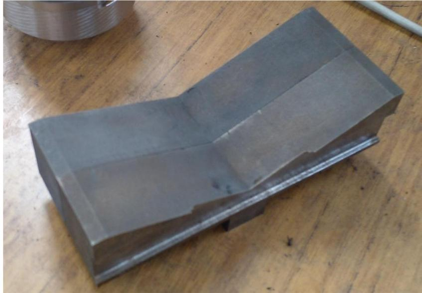
**Figura 4.7.4-1.** Cuñas de centrado para mecanizado del Cuerpo Cámara en la fresadora CNC del taller.
