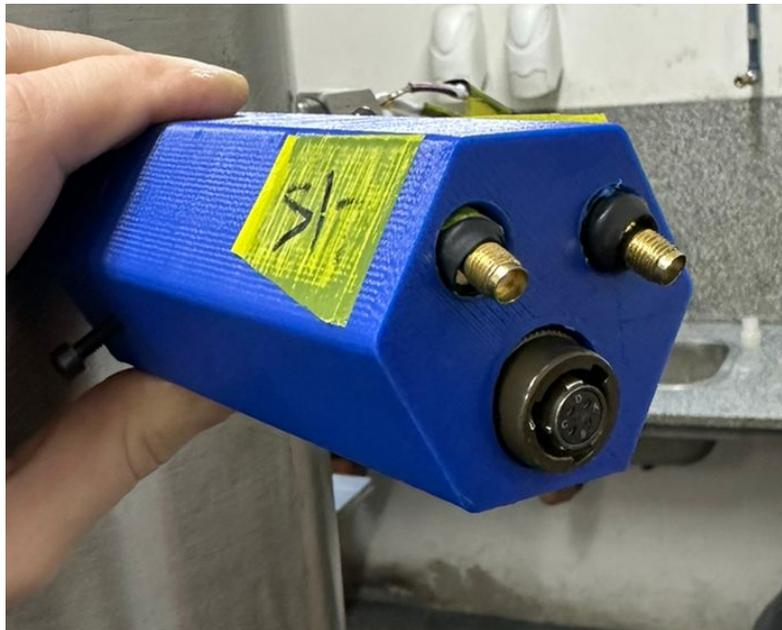
**Figura 6.6-4:** Cobertura de las conexiones exteriores.
