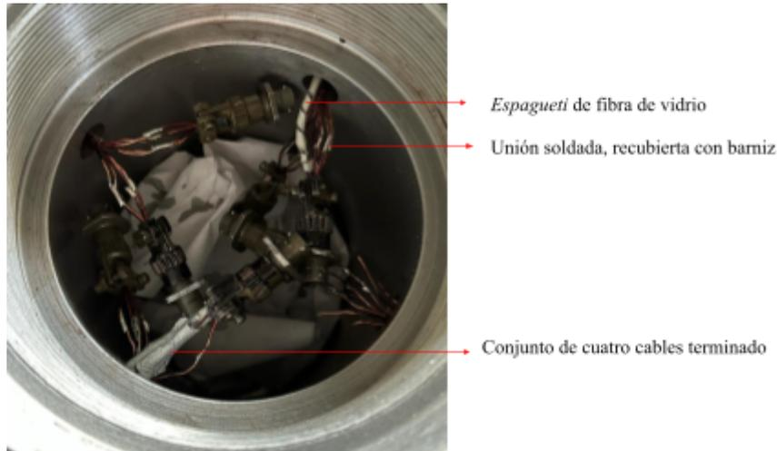
**Figura 6.6-5:** Aislación de las conexiones.
