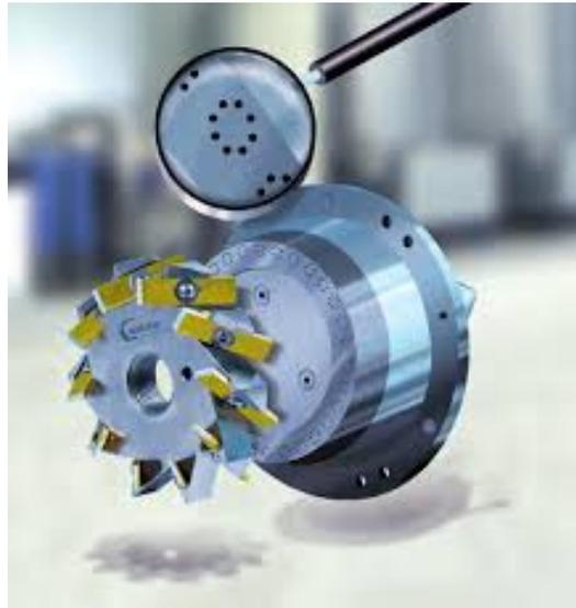
Figura 2.8: Foto del plato de extrusión con agujeros y la cuchilla
