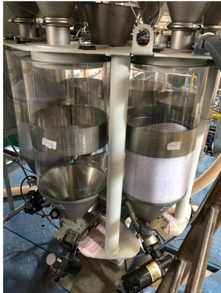
Figura 2.6: Tolvas alimentadoras de la máquina Sulzer
