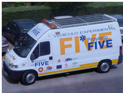
*Figura 2.05 - Ambulancia con sistema fotovoltaico autónomo.*
