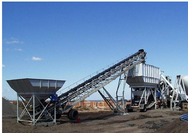
Figura 41: Sistema de carga Indumix SCM 18.
