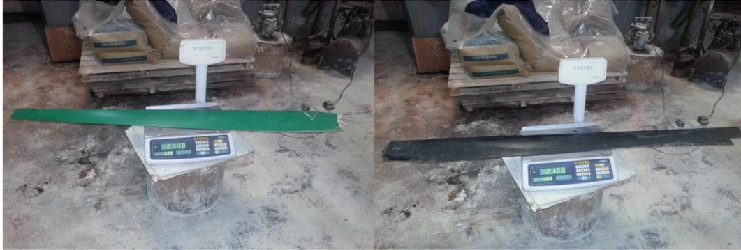
Figura 16. Pesaje de dos ejemplares de aspa
