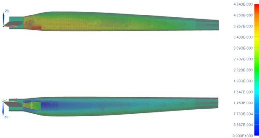
Figura 45. Deformaciones ante cargas nominales
