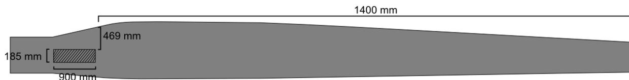
Figura 33. Esquema de la superficie de sujeción de la pala
