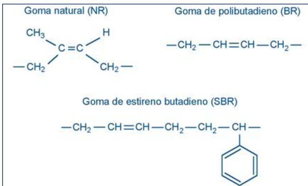
Figura 2.1. Estructura molecular de los diferentes tipos de gomas<sup>1</sup>
