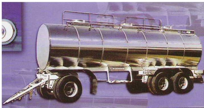
Figura VII-34. Semirremolque Cisterna con Chasis
