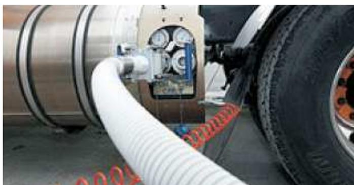
Figura VII-31. Camión Cisterna de Almacenamiento Criogénico
