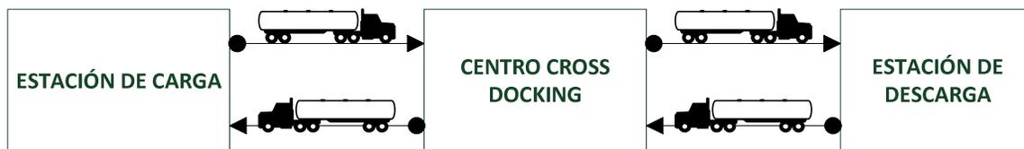
Figura IX-1. Sistema de Transporte con Cross Docking
