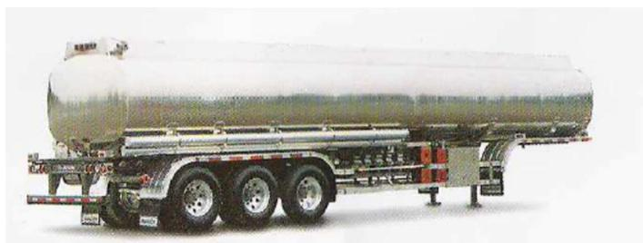
Figura VII-35. Semirremolque Cisterna sin Bastidor
