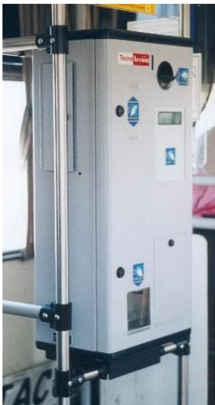
Figura 3.4-2: Equipo mixto que combina el cobro con tarjetas de prepago sin contacto y monedas.
