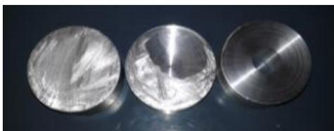
Ilustración 51: Resultados del torneado de la brida en tres pasos.
