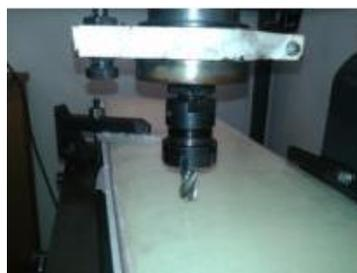
Ilustración 42: Agujero con fresa de diámetro 10mm.
