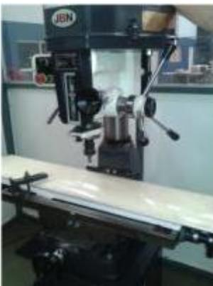
Ilustración 41: Agujero con fresa de diámetro 16mm.
