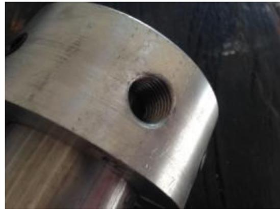
Ilustración 54: Pieza finalizada, vista de rosca interna
