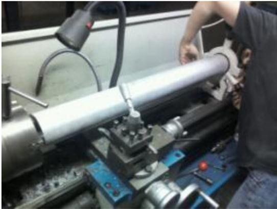
Ilustración 59: Torneado del eje secundario
