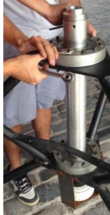
Ilustración 64: Montaje bridas
