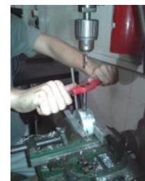
Ilustración 52: Mecanizado Rosca Interna
