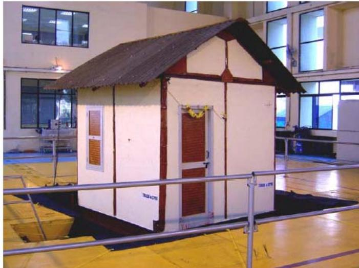
Fig. 6.3-2 Vivienda de bambú montada sobre tabla vibratoria para prueba sísmica
