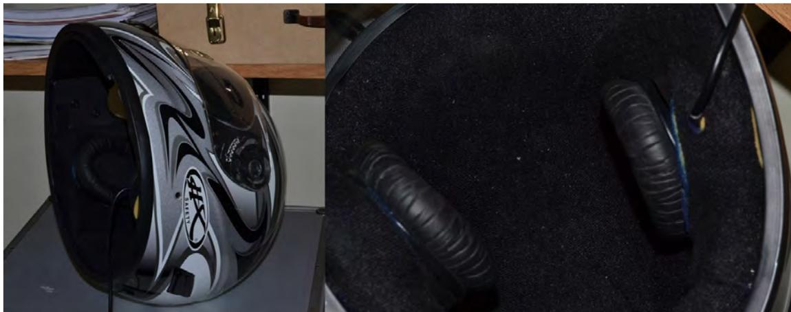
**Figura 3-3:** Se muestra el casco utilizado y la intervención y adaptación de los auriculares en su interior.
