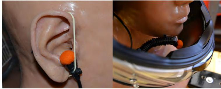
**Figura 3-16:** Izquierda: ubicación del micrófono de error. Derecha: ubicación del micrófono de referencia.
