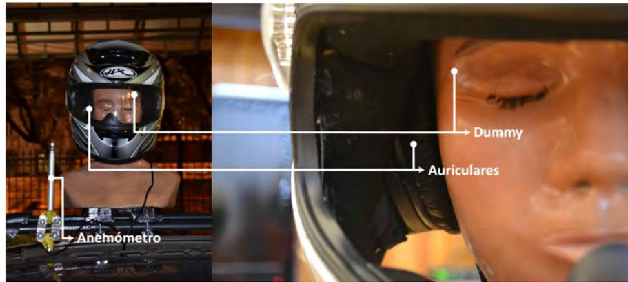
**Figura 3-21:** Esquema general del setup. Se visualiza la ubicación del anemómetro.
