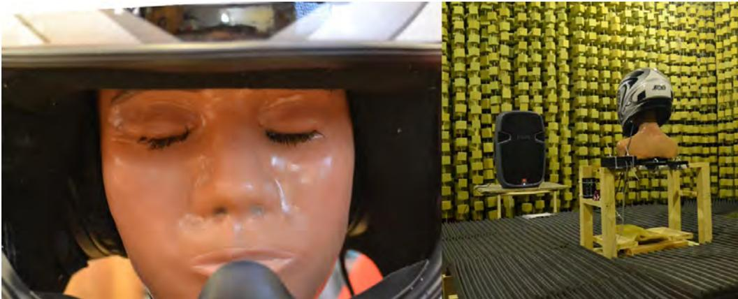
**Figura 3-6:** A la izquierda casco con auriculares y Dummy. A la derecha en situación de medición.
