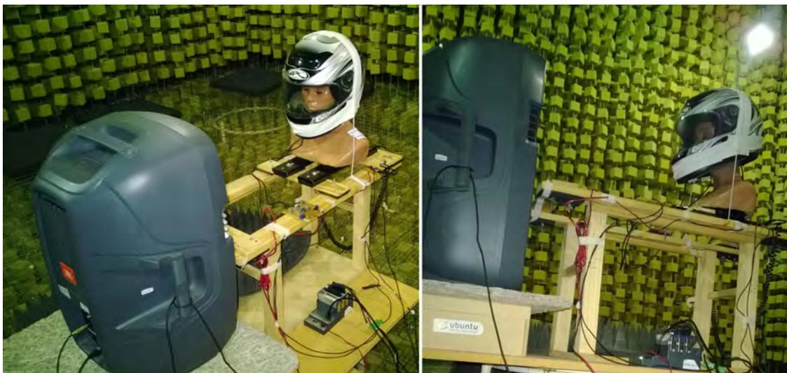
**Figura 3-2:** Experimentos de identificación y control. Se observa la posición del Dummy así como también el altavoz y su posición dentro de la cámara anecoica.
