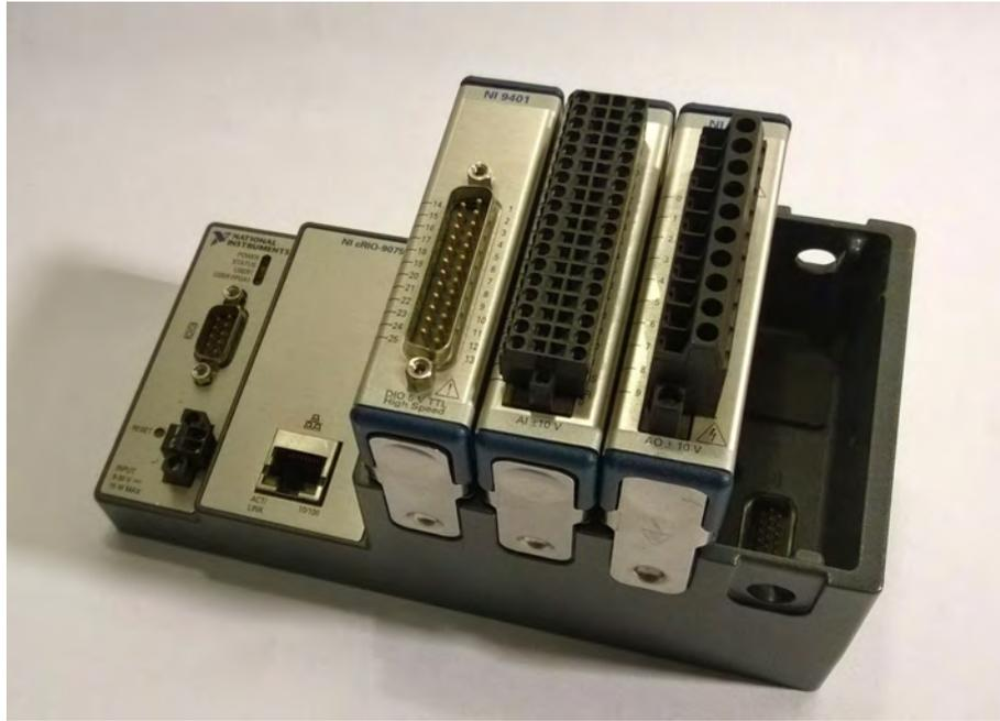
**Figura 3-19:** Compact-RIO NI-9075. Pueden observarse en la imagen la ubicación de cada uno de los tres módulos, de izquierda a derecha: NI-9401, NI-9205 y NI-9263.
