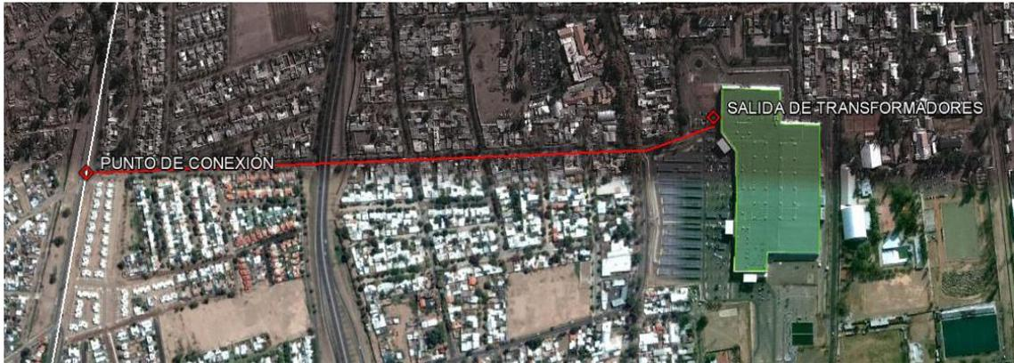
Ilustración 67. Conexión al SADI, línea en 33 kV (1 km). Fuente: elaboración propia en GoogleEarth.
