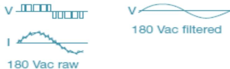
Ilustración 56. Efecto de los filtros y suavizadores presentes en inversores. Fuente: Worden and Zuercher-Martinson, How Inverters Work.
