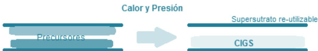
Ilustración 34. Esquema de fabricación de combinación por presión y calor (FASST). Fuente: elaboración propia.
