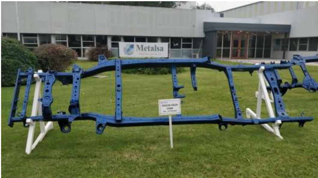
*Imagen 1.3.6. Chasis para Toyota Hilux exhibido en la planta. Elaboración propia.*
