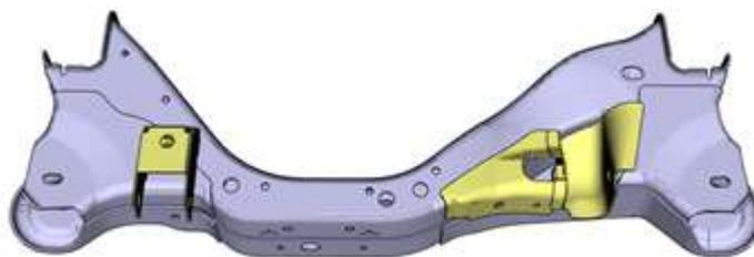
*Imagen 2.1.6.3. Cross Member de un chasis. Provisto por Metalsa.*
