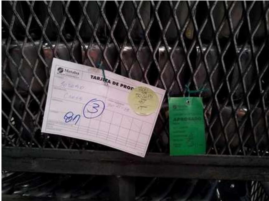
*Imagen 2.1.10.1. Ejemplo de tarjeta Kanban empleada en Metalsa. Fotografía de elaboración propia.*
