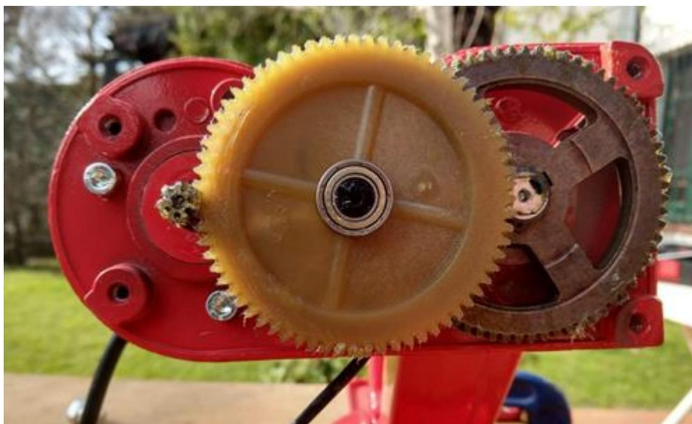
Figura 10-15 Reducción del motor.
