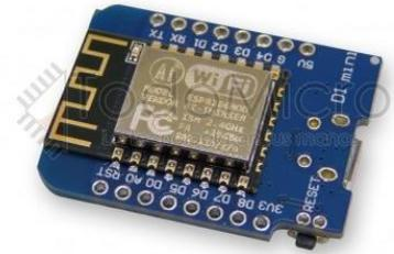
Figura 10-3 Módulo ESP para comunicaciones
