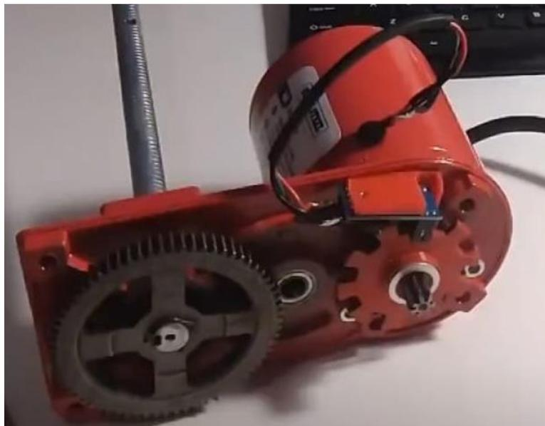
Figura 11-14 Montaje del sensor de velocidad.
