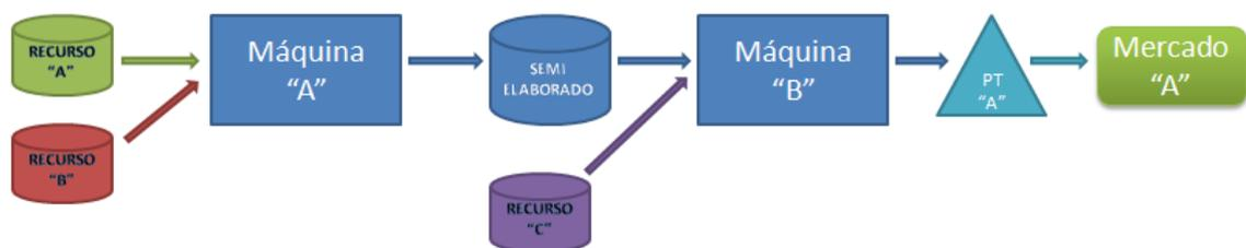
**Figura 7.1.** Línea de producción con stock de semielaborado.
