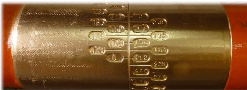
Figura A5.6: *Adjusting Ring* de un motor de fondo NOV, fotografía propia.
