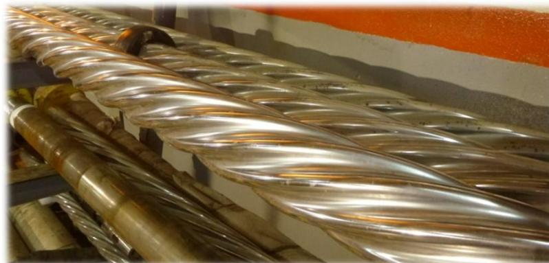
Figura A5.5: Rotor de un motor de fondo NOV, Fotografía propia.
