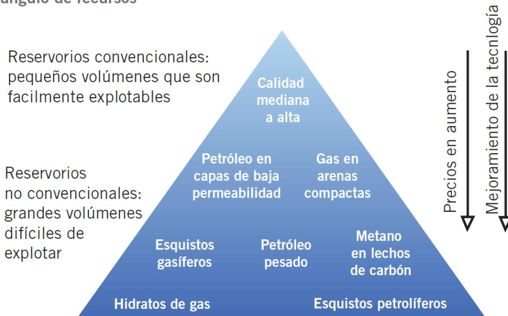
Figura 1.5: Triángulo de recursos para reservorios, NPC Global Oil & Gas.
