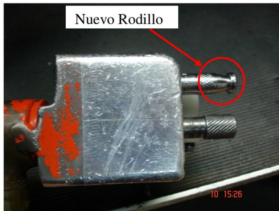
Foto 6.1- Foto de Cabezal del Roll-Forming indicado nuevo Rodillo.
