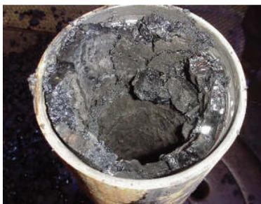
Fig. 2- Asfaltenos en línea flujo
