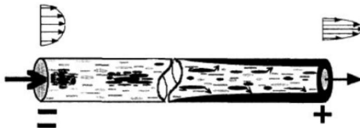
Fig.17- Deposición electrocinética. (Delgado, 2006)
