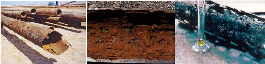
*Fig. 5 - Corrosión interna de tubulares. (Revensub, 2016)*
