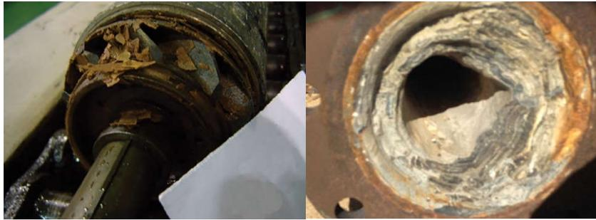
*Fig.4 - Obstrucción en tubería y en Impeler de ESP por incrustaciones (Merus, 2016)*
