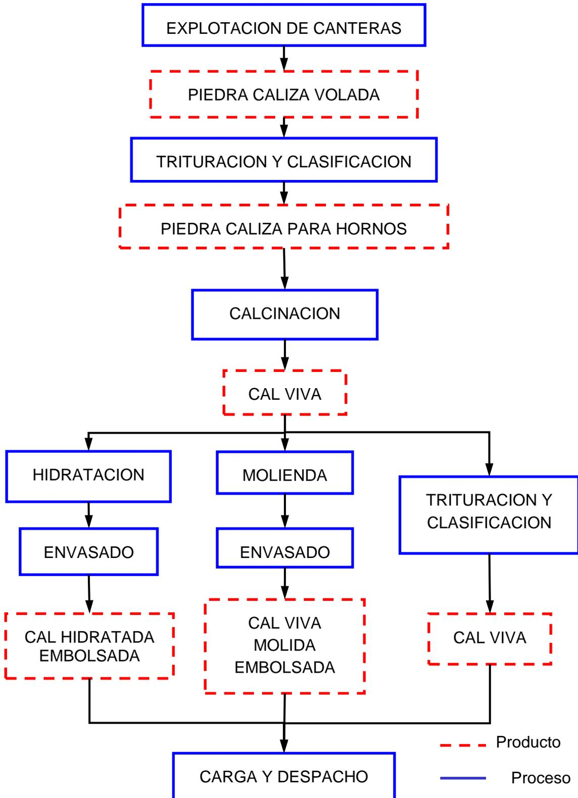
Figura 3-1. Proceso de producción de Cal
