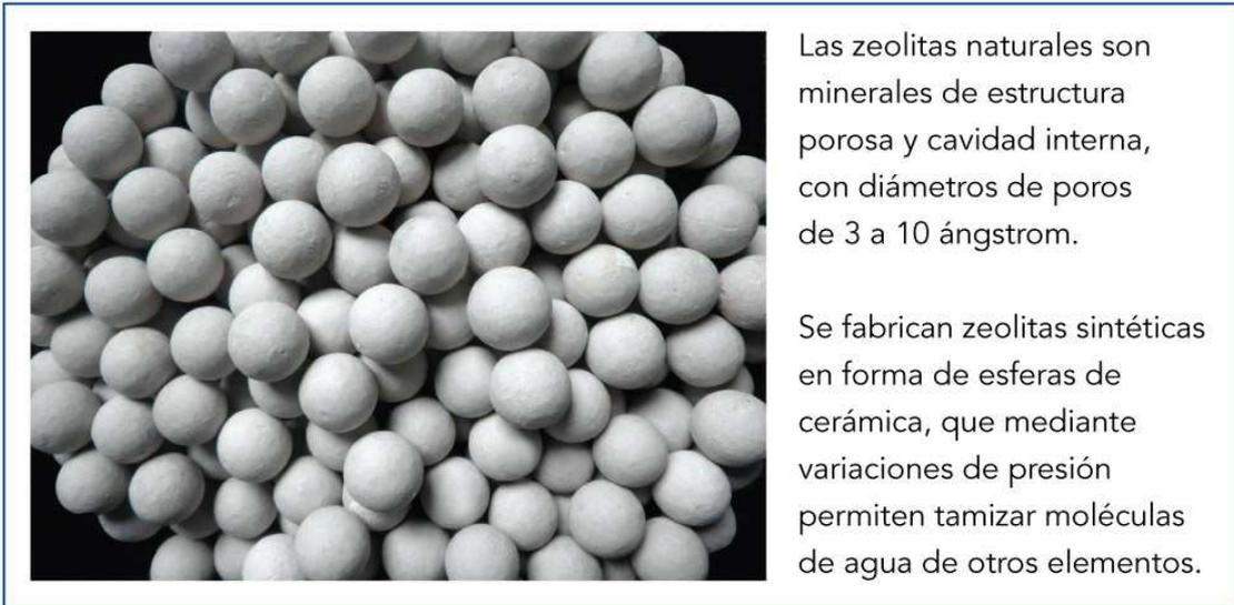
El proceso produce una corriente de salida de alcohol sin agua (deshidratado), mientras que el agua queda retenida en el lecho para después ser removida.
