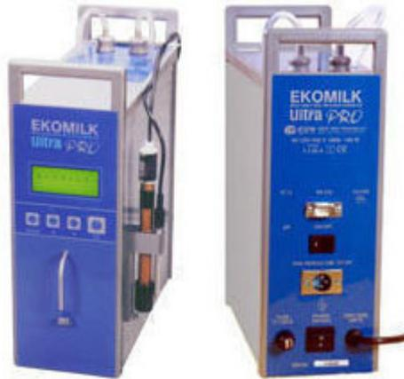
**Foto 3.3** Sensor Ekomilk Ultra Pro utilizado por Lácteos Santa Fe para medir la calidad de la leche previa a la elaboración. Fuente: catálogo online de Ekomilk.
