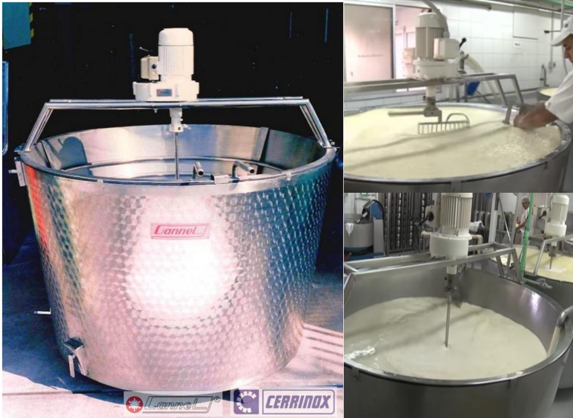
**Foto 3.6 Izquierda:** tinas de 1000 lts/hora brindadas por Cerrinox similares a las utilizadas en Lácteos Santa Fe. **Fuente:** catálogo online de Cerrinox S.A. **Derecha Arriba y Abajo:** imágenes de las tinas en la planta. Las tinas poseen una mezcladora pero la cuajada se liran manualmente (imagen superior)
