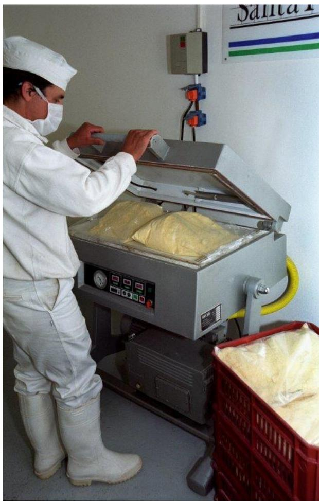
**Foto 3.10** Envasadora al vacío ubicada en Martínez. La máquina genera una atmósfera de vacío logrando el sellado de los productos. **Fuente:** imagen propia
