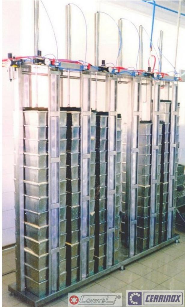
**Foto 3.9** Prensa neumática utilizada en Lácteos Santa Fe **Fuente:** catálogo online de Cerrinox
