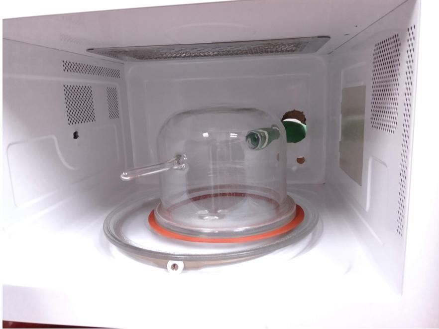
Figura 23: Interior del microondas con la cámara de vacío donde se genera el plasma.
