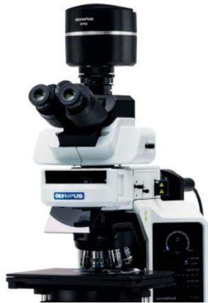
Figura 30: Microscopio Olympus BX63/BX53. Imagen tomada del catálogo del producto BX63/BX53 de Olympus
