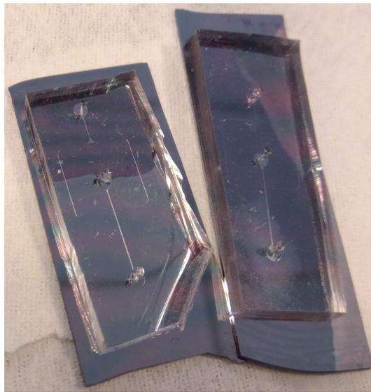
Figura 25: Dispositivos de PDMS en superficie de  $\text{SiO}_2$
